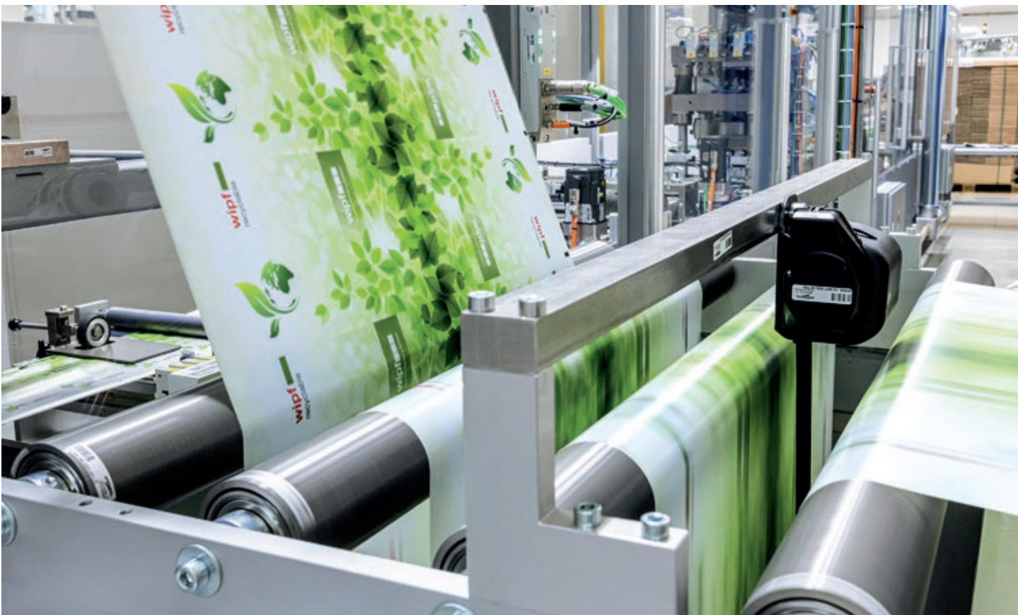
Produktion nachhaltiger Verpackungen aus recycelbarem Monomaterial auf der neuen Ultraschall-Beutelanlage der Wipf AG
