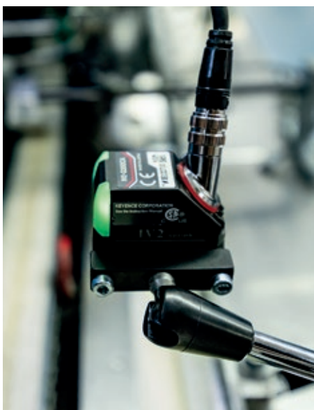
Eigens entwickeltes Kamerasystem für eine einwandfreie Sprachenzuteilung von Brief und Beilage
